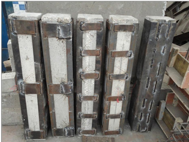
Figure 35 : Différents types de chemisage en acier
