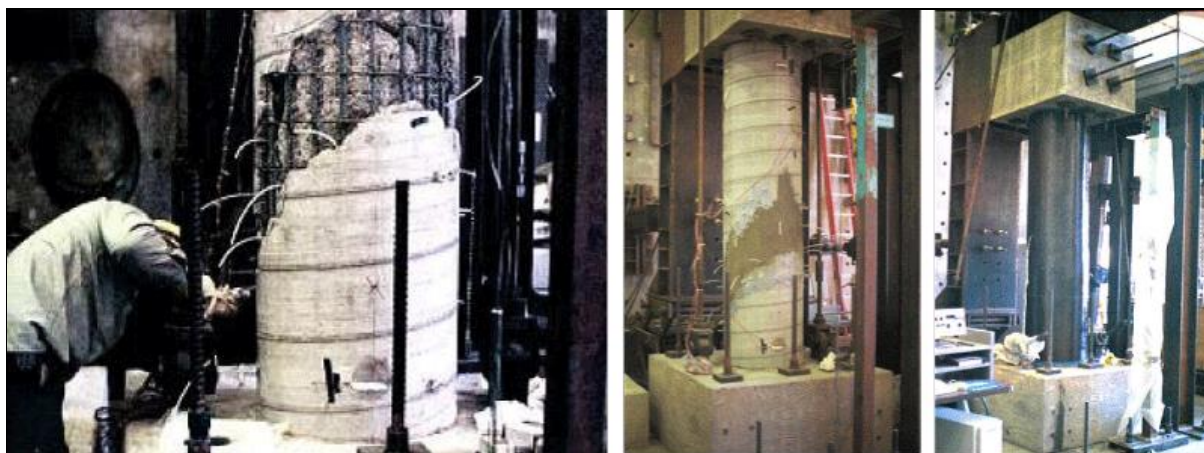
Figure 28 : Traitement et renforcement par PRFC
