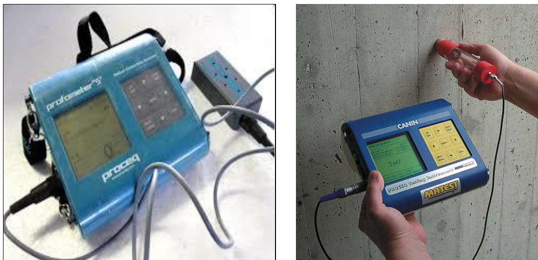
Figure 9 : Profomètre (à gauche) – Canin (à droite)
