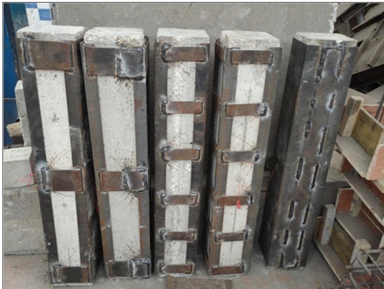
Figure 35 : Différents types de chemisage en acier
