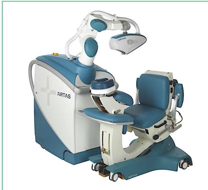
Figure 28. Représentation du robot ARTAS®.
