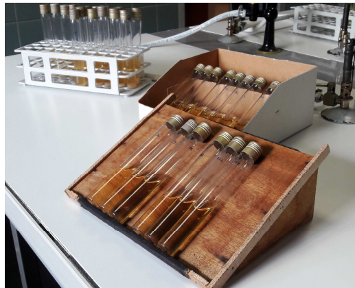
Figure 9 : Inclinaison des tubes à 30° (crédit photo A. JABOL)
