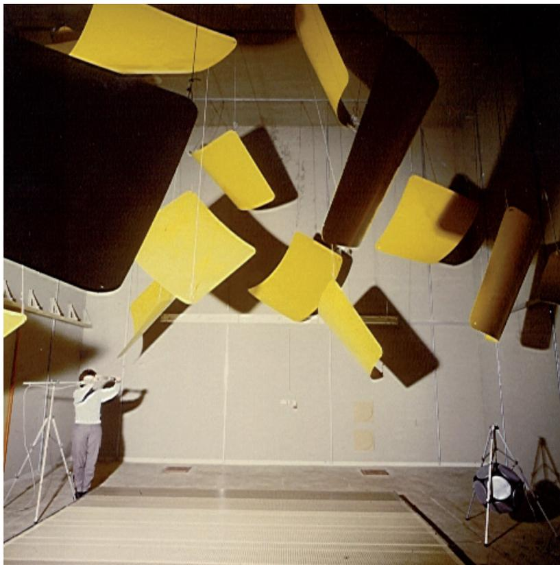
Fig. 36. Chambre réverbérante (Hallraum) de l'Institut Fraunhofer de physique du bâtiment (Fraunhofer Institut für Bauphysik). Aire :  $60\text{m}^2$ . Volume :  $392\text{m}^3$ . ©Foto Fraunhofer IBP
