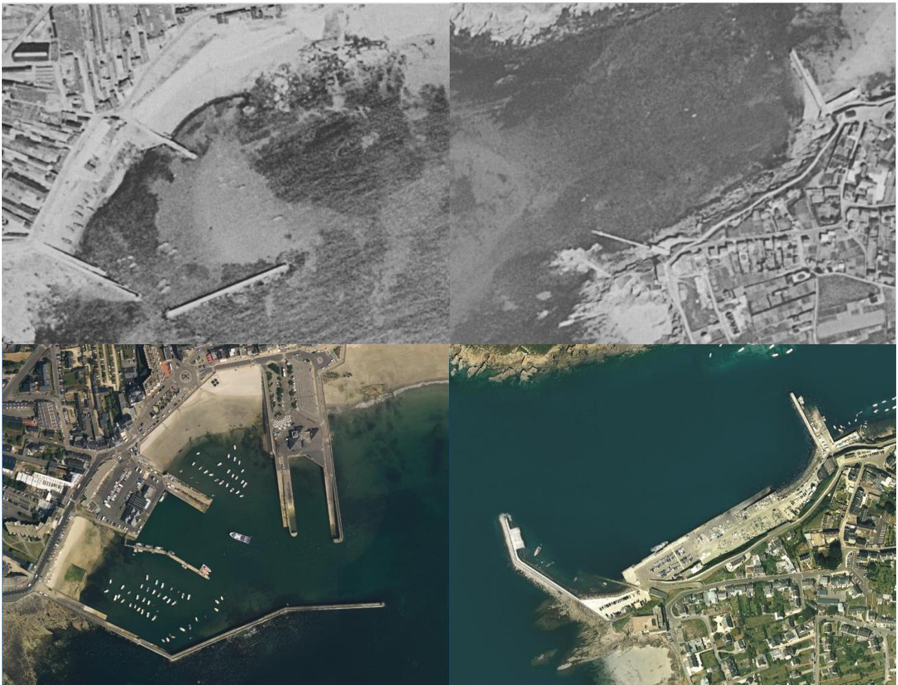
Figure 5: Évolution de Port-Maria (Quiberon ; à gauche) et du port du Conquet (à droite) entre 1950 et 2012. L'agrandissement des digues ainsi que la création de terre-pleins sont particulièrement bien visibles. (Source : IGN)
