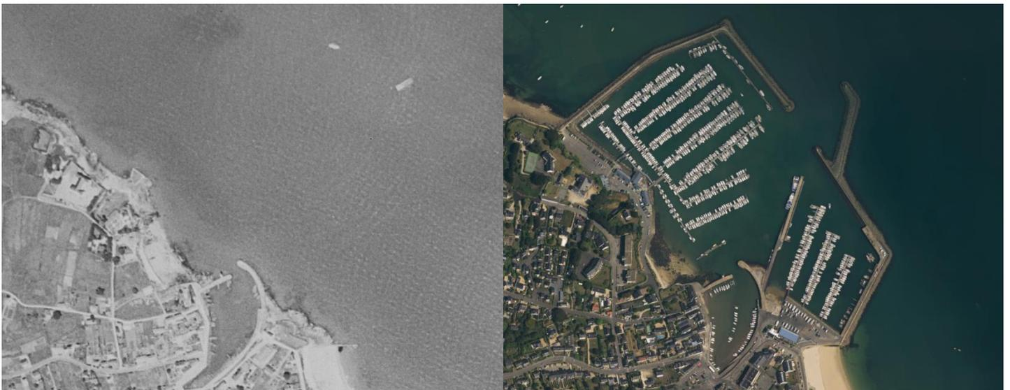
*Figure 6: Évolution de Port-Haliguen (Quiberon) entre 1950 et 2013. On voit bien ici l'importance qu'a prise la plaisance dans la baie de Quiberon, à proximité du golfe du Morbihan. L'usage des pontons permet une organisation de l'espace en densifiant les stationnements pour des embarcations de plus en plus nombreuses. Les digues, qui ceignent le port de toutes parts, témoignent de la variabilité des courants dans ce secteur. (Source : IGN)*
