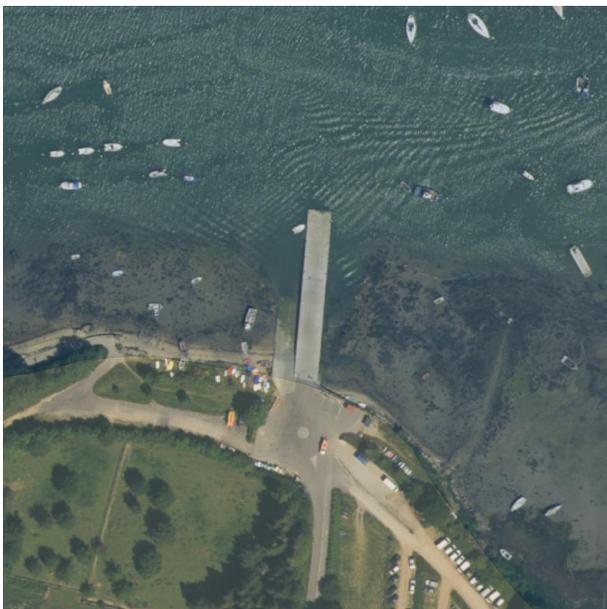
Figure 10: La cale de Barrarac'h dans le Golfe du Morbihan (56), un exemple de port en « épi » (Source : IGN)
