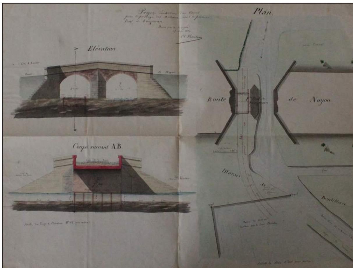
fig. 63 : Dessin de modification de l'Avre et du pont de Longueau (source : 99S489/5)
