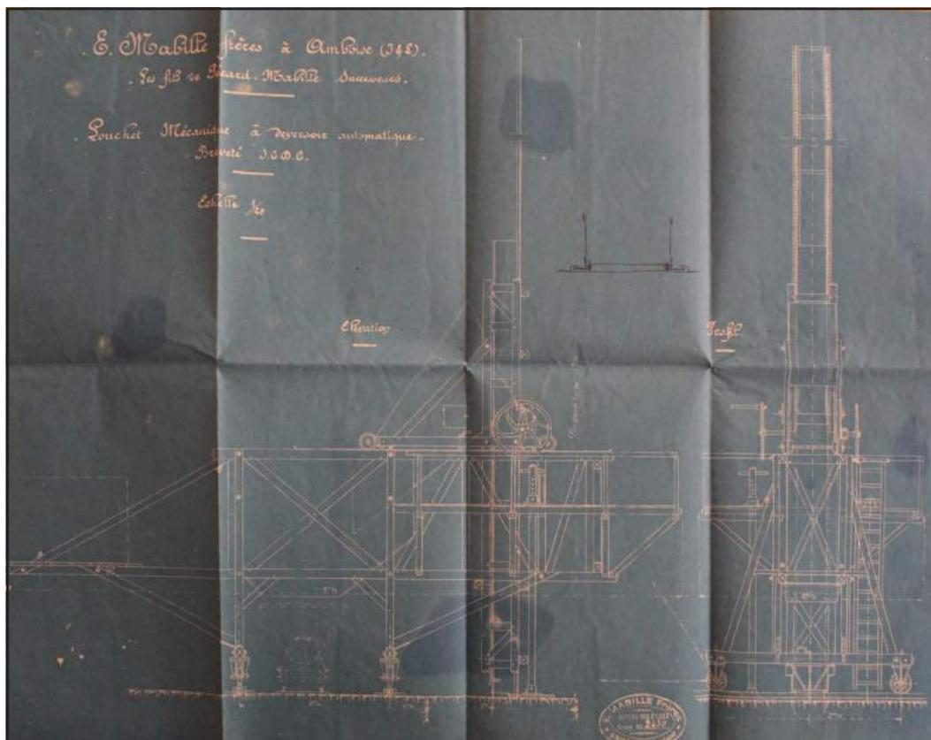
fig. 48 : Plan de fabrication d'un extracteur mécanique (source : 99S378576)
