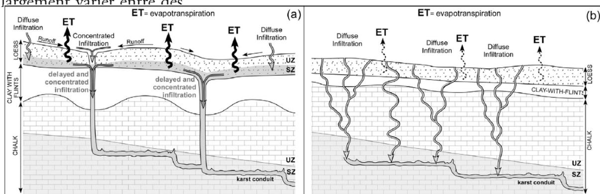
fig. 12 : Modèle de l'infiltration de l'eau avec (a) des argiles à silex épais et (b) des argiles à silex peu épais (source : Barhoum S., 2015)
