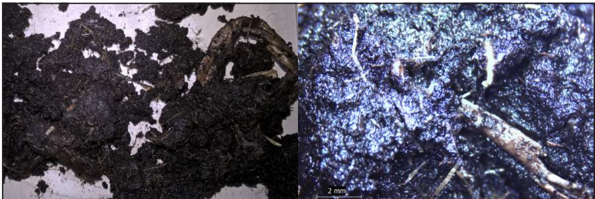
fig. 27 : Photographies macroscopique (à gauche) et à la loupe binoculaire (à droite) de la tourbe noire (A. Soudry)
