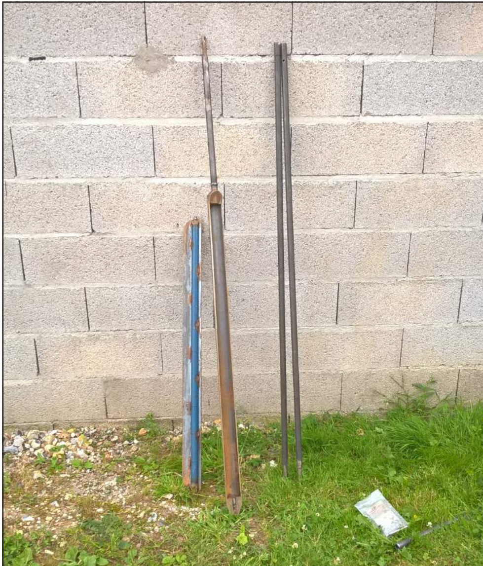
fig. 22 : Photographie d'un carottier démonté (gouge, lame et rallonges) (photographie : A. Soudry)
