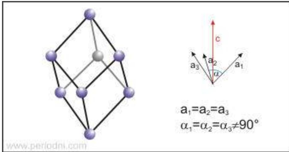
fig. 10 : Schéma d'une structure rhomboédrique (source : <http://www.zpag.net/Chimie/struct.htm>)
