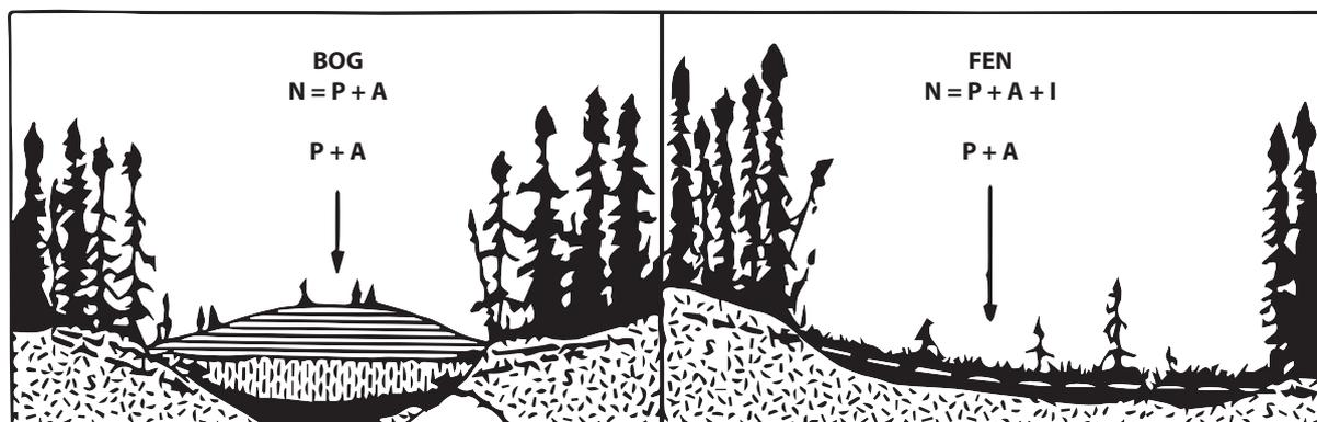
fig. 15 : Différenciation typologique des apports d'eau et de nutriment entre un *bog* et un *fen* (N = Source d'éléments nutritifs ; P = Précipitations ; A = Poussières atmosphériques ; I = Infiltrations) (source : Conseil nord-américain de conservation des terres humides, 1992 ; DAO : A. Soudry)
