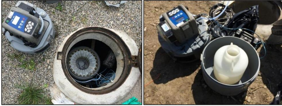
Figure 2-11 : Préleveur 24 flacons en entrée (gauche) et monoflacon en sortie (droite)
