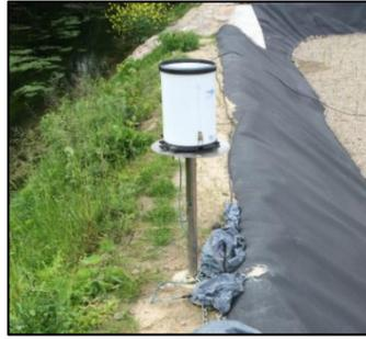
Figure 2-6 : Pluviomètre à auget basculant installé sur site (03/06/2016)
