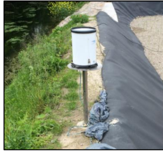
Figure 2-6 : Pluviomètre à auget basculant installé sur site (03/06/2016)
