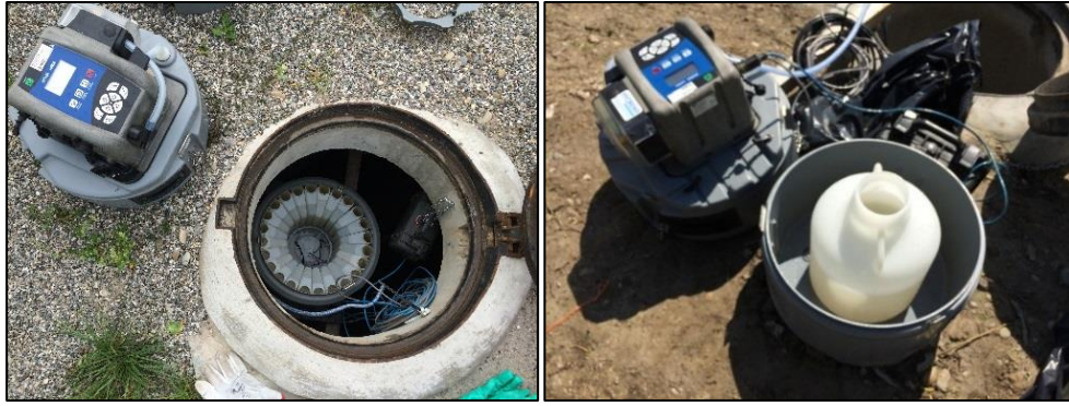
Figure 2-11 : Préleveur 24 flacons en entrée (gauche) et monoflacon en sortie (droite) (29/04/2016)
