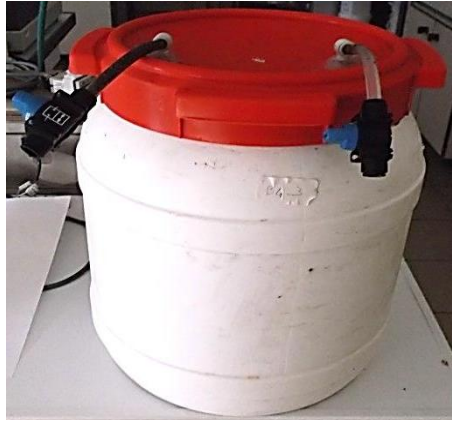
Figure 18 : bidon-méthaniseur réalisé en laboratoire pour les essais de digestion.
