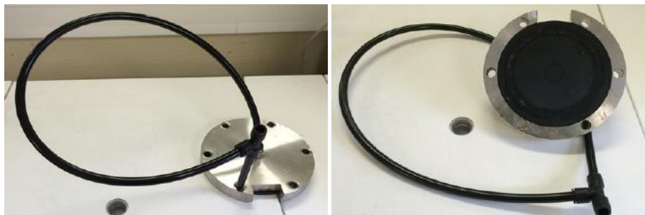
Figure 17 : Membrane en caoutchouc utilisée lors de la phase de compactage du gâteau de boue.
