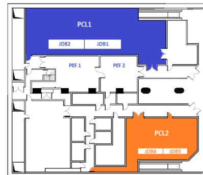
Figure 51: locaux électriques de la station Saint-Charles
