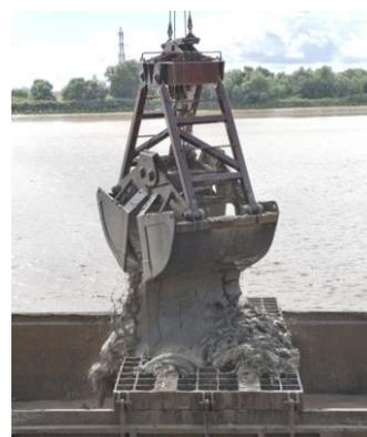
*Figure 8, Photo d'une drague mécanique avec benne preneuse, source : CETMEF,2010*
