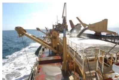
*Figure 6 - Drague Aspiratrice en Marche (DAM), Source: : GIS SIEGMA<sup>12</sup>*
