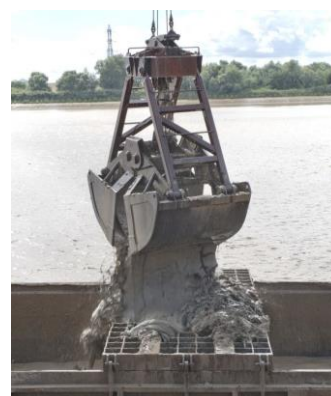
Figure 8, Photo d'une drague mécanique avec benne preneuse, source : CETMEF,2010
