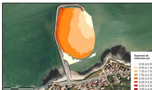
Figure 16 - Epaisseur des sédiments à draguer lors des opérations prévues pour 2012, Source: La Plaine sur Mer, 2012
