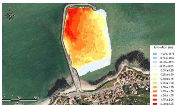
Figure 15 - différentielle bathymétrique entre 2005 (après dragage) et 2011, Source: La Plaine sur Mer, 2012
