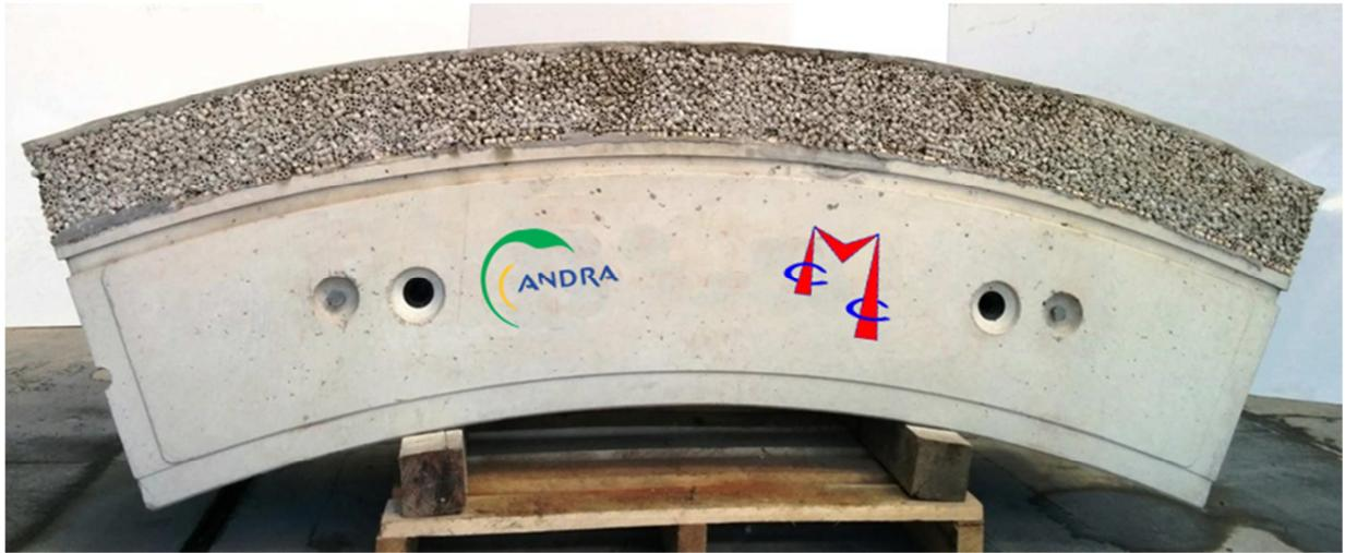
Figure 30. Prototypé de voussoir compressible. Source interne CMC
