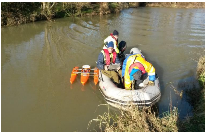
Figure 4: Relevés bathymétriques avec l'ADCP.
