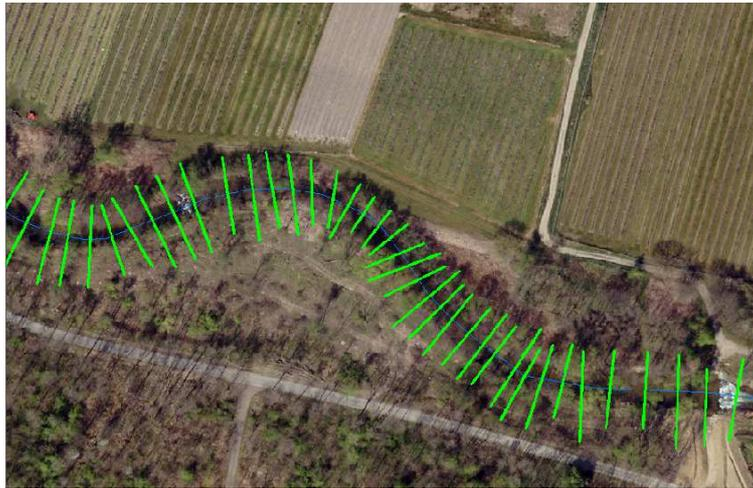
**Figure 13 : Représentation des profils en travers pour le traitement sous HEC-RAS**
