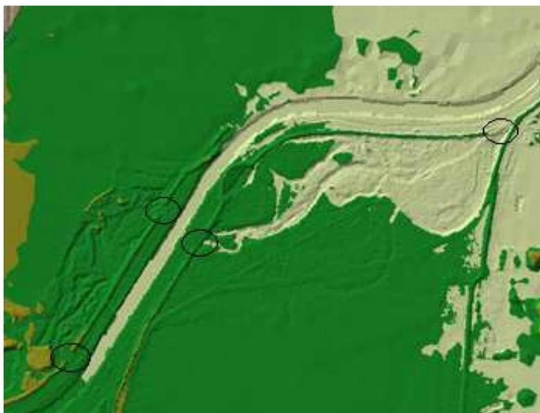
Figure 25 : Topographie pour la reconnexion par ouverture de digues et emplacement des ouvertures
