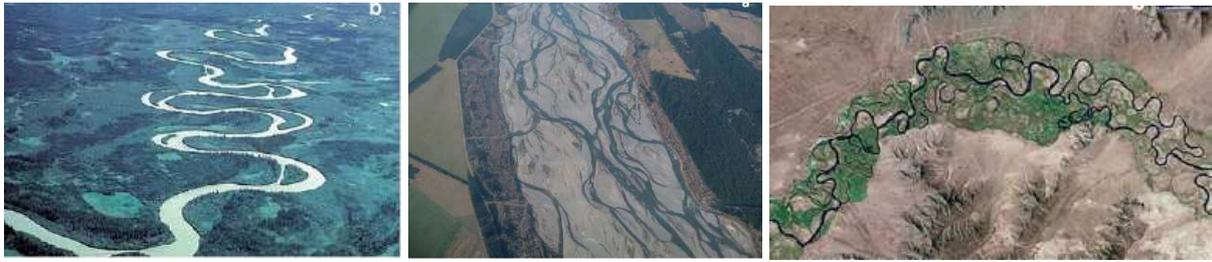
Figure 3 : Styles fluviaux (Source : Malavoi et Bravard, 2010). a) Méandrage b) Tressage c) Anastomose
