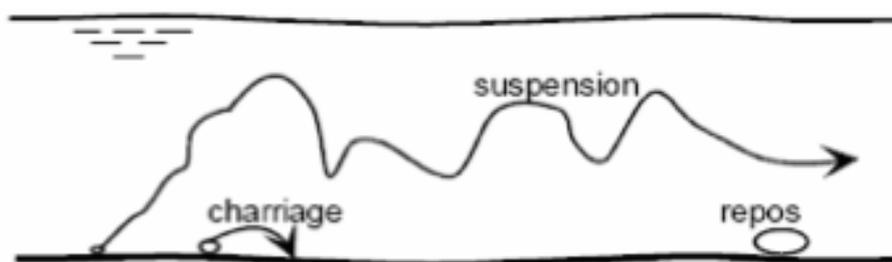
Figure 9 : Formes de transport solide (Source : Degoutte, 2006)
