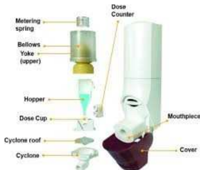
Illustration 11: Description du système Easi-breathe® (68).
