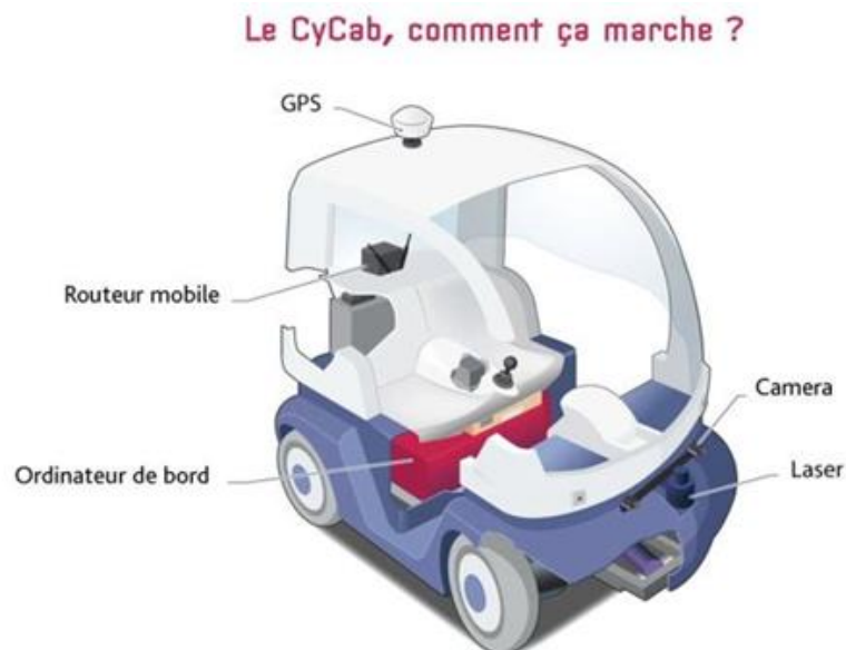
Figure 6 : Un Cycab de l'INRIA et ses différents équipements. Source : INRIA
