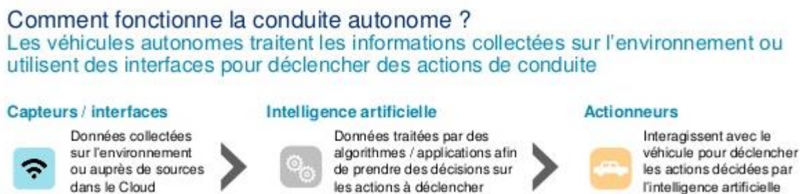
Figure 11 : Schéma qui présente les trois grandes fonctions des véhicules autonomes avec les capteurs (la perception), l'intelligence artificielle (la planification) et les actionneurs (le contrôle). Source : Oliver Wyman, Daimler
