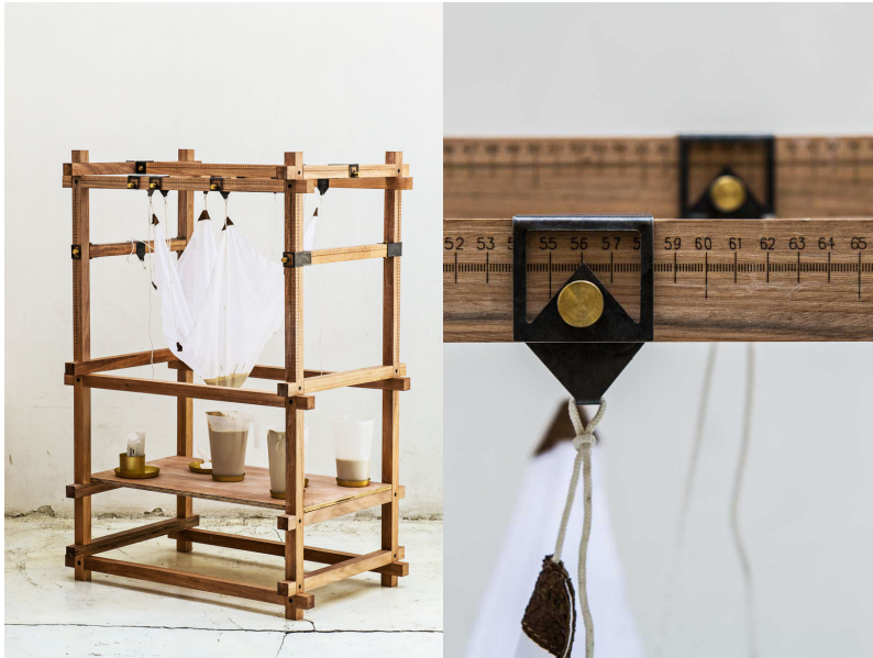
Imprimante 3D analogue servant à faire du design paramétrique sans ordinateurs. Source : http://www.gt2p.com/
