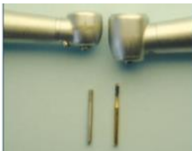
Figure 25 : Un contre angle ayant une tête plus petite (contre angle pour enfant par exemple) combiné avec des fraises en carbure de tungstène de 3 mm au lieu de 4 mm permettra d'améliorer considérablement l'accès et le traitement
