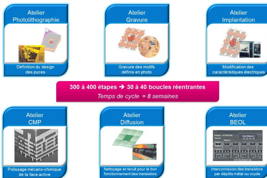
Figure 1 : Etapes de fabrication des puces
