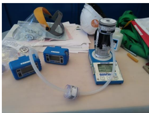
Figure 12 - Matériel utilisé lors des mesurages des polluants au poste de travail
