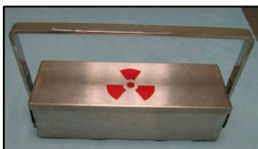
[Photographie 5.11] – Valisette blindée utilisée pour le transport de la seringue de Pulmocis®.
