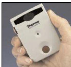
*[Photographie 1.2] – Dosimètre électronique pour le suivi dosimétrique opérationnel.*
