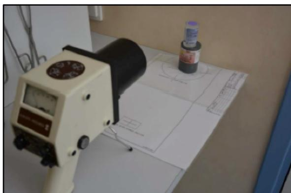
[Photographie 3.5] – Mesure du débit de dose à 30 cm des TheraSphere<sup>®</sup> dans leur flacon à la Babyline<sup>®</sup>.
