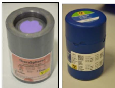
[Photographie 2.1] et [Photographie 2.2] – Flacons de Theraspheres® et SIR-Spheres® dans leur pot plombé.
