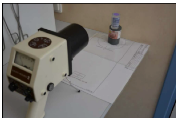
[Photographie 3.5] – Mesure du débit de dose à 30 cm des TheraSphere ® dans leur flacon à la Babyline ® .
