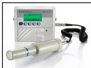
[Photographie 5.18] – Débitmètre LB213 pour la mesure à 30 cm du flacon des TheraSphere®.
