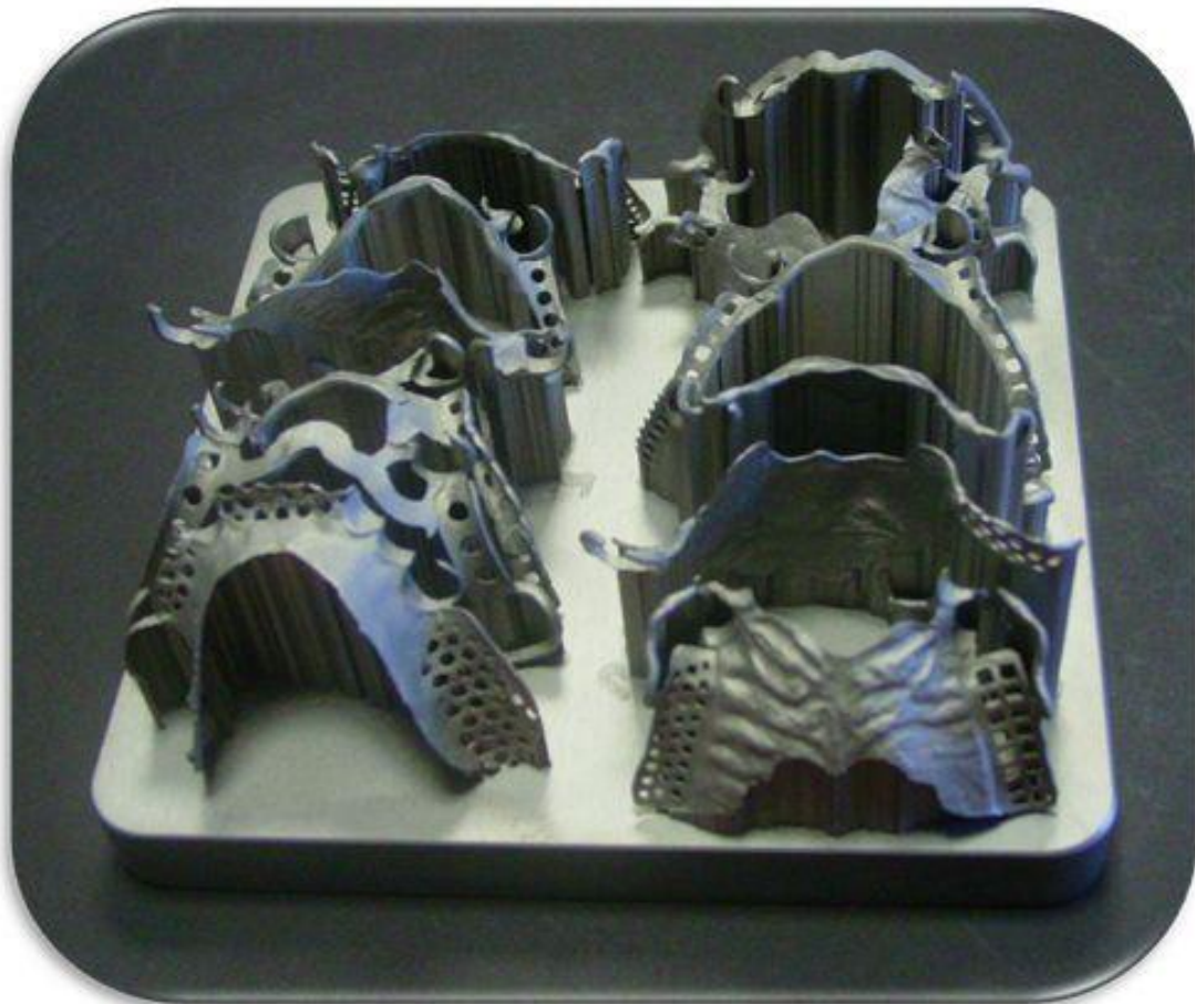
Exemple de PBM réalisées par microfusion laser par St Rémi dentaire, laboratoire de prothèse sur Reims.
