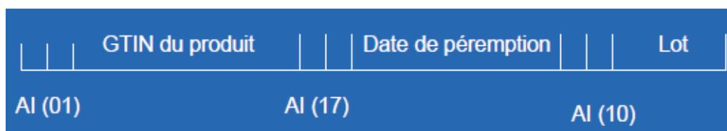
**Figure 2: Schéma d'un code GS1 couramment retrouvé sur les DMI**
