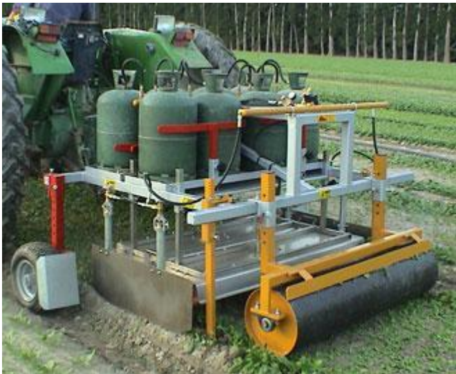
Figure 4: Machine de destruction thermique fonctionnant au gaz (Sinquin, 2017)
