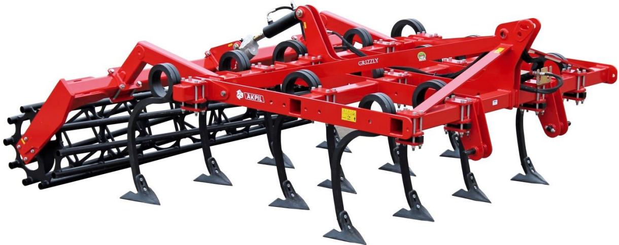
Figure 1: Bineuse patte d'oie Grizzly de la marque Akpil France (Akpil France, 2017)
