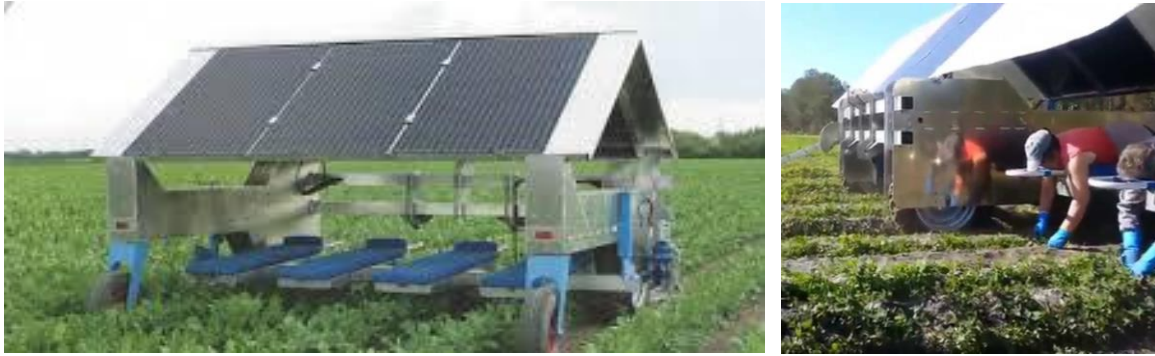
Figure 6: Photographies du portique de désherbage manuel autoguidé à énergie solaire du fabricant De Jongh (Stecomat, 2017)
