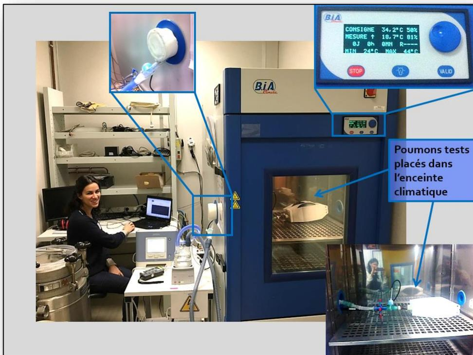
*Les poumons tests sont placés dans l'enceinte climatique qui permet le maintien d'une température constante similaire à la température corporelle. Elle est réglée à 34°C (température au niveau de la carène). Le reste du montage (circuit respiratoire, humidificateur et ventilateur) est à température ambiante en dehors de l'enceinte climatique.*
