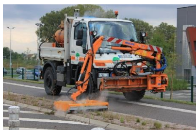
Figure 8 : Machine de désherbage à la vapeur d'eau ; Source : SCOP EV, 2016
