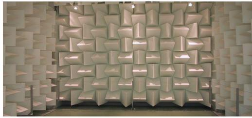
Figure 1. Salle semi-anéchoïque (Source : Ifsttar – LAE)
