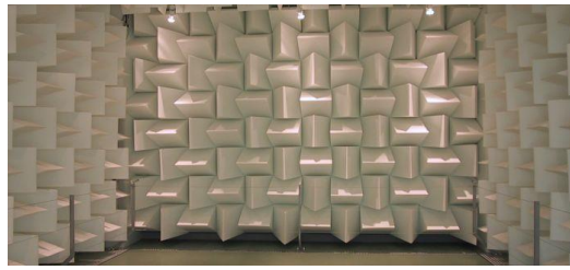
Figure 1. Salle semi-anéchoïque (Source : Ifsttar – LAE)
