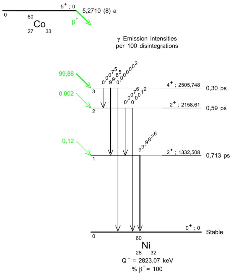
FIGURE 1.4 – Schéma de la désintégration du Cobalt 60.
