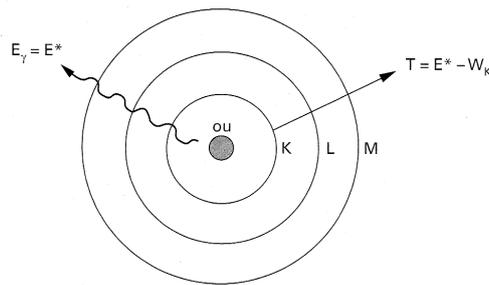
FIGURE 1.3 – Schéma des mécanismes de désexcitation nucléaire.
