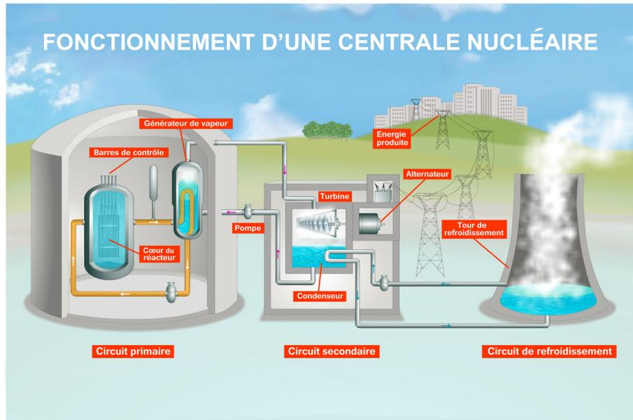
FIGURE 1.1 – Schéma du fonctionnement d'un REP.
