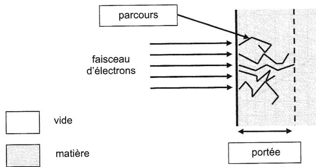
FIGURE 1.5 – Parcours et portée d'un faisceau d'électrons.
