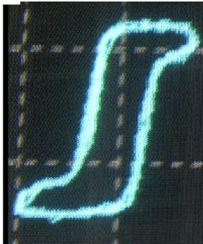
Figure 3.8 - Cycle d'hystérésis, Tension 1V/cm, Courant 5A/cm
