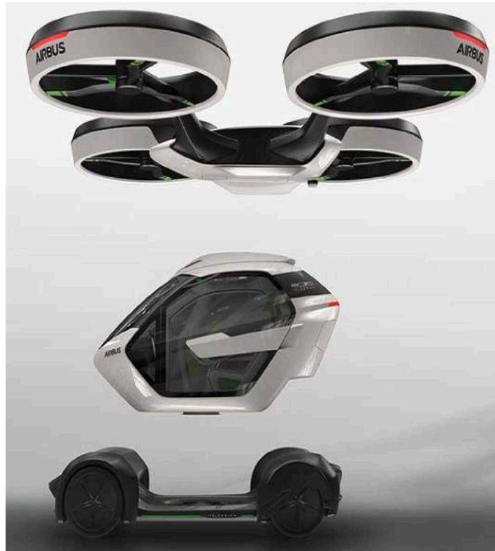
Airbus Pop.Up, composé d'un drone quadrirotor, associé à un habitacle deux places, et à un châssis automobile électrique. Ces parties pouvant se connecter à volonté.
