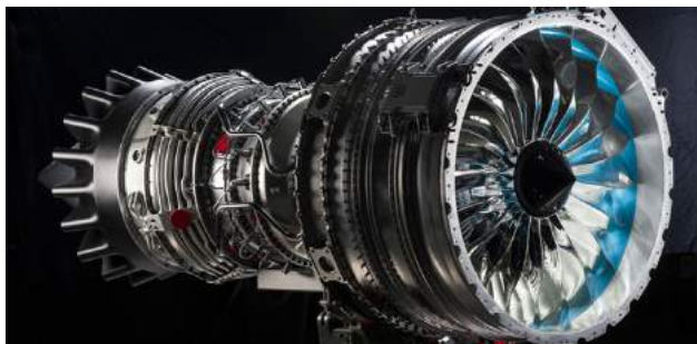
Réacteur Silvercrest de Safran Aircraft Engines
