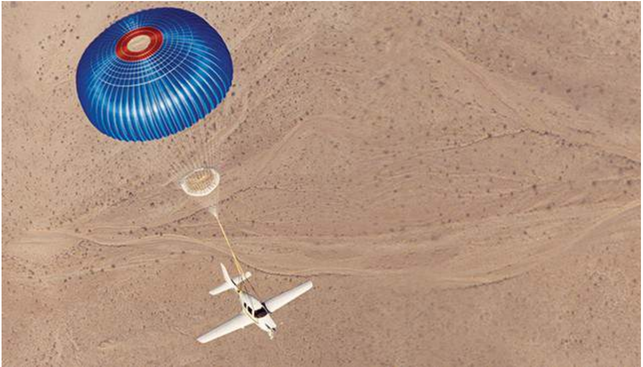
Un Cirrus avec son CAPS déployé lors d'un vol d'essai visant à vérifier les performances du parachute et à les comparer avec les simulations informatiques.
