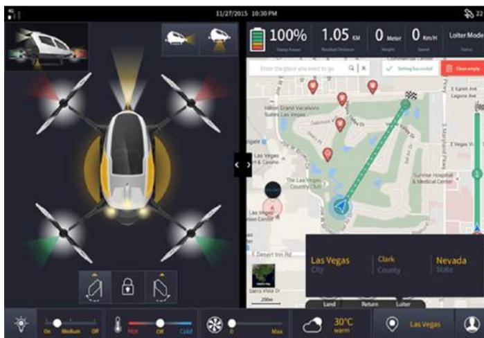
*Interface de l'application utilisée par le passager à bord d'un Ehang 184, lui permettant de définir son trajet, de connaître les paramètres de vol, d'allumer les phares, d'actionner les portières ou d'interrompre le vol en cas de problème.*
