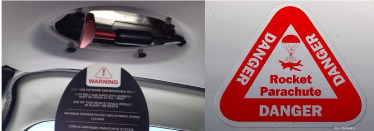
*Le pilote a simplement à retirer un cache situé sur le plafond du cockpit et à tirer cette poignée rouge, déclenchant ainsi le dispositif, puis à préparer l'appareil ainsi que les passagers à l'atterrissage sous parachute qui peut tout de même être légèrement brutal.*
