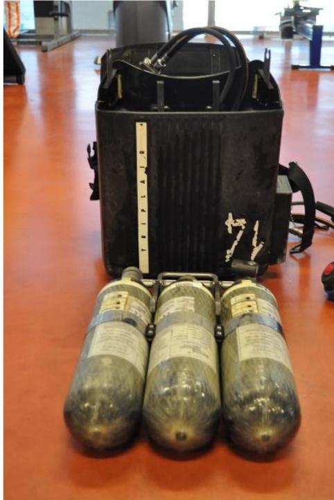
Figure 4 : ARI dit « TRIPLAIR ® » : carter et bloc bouteilles
