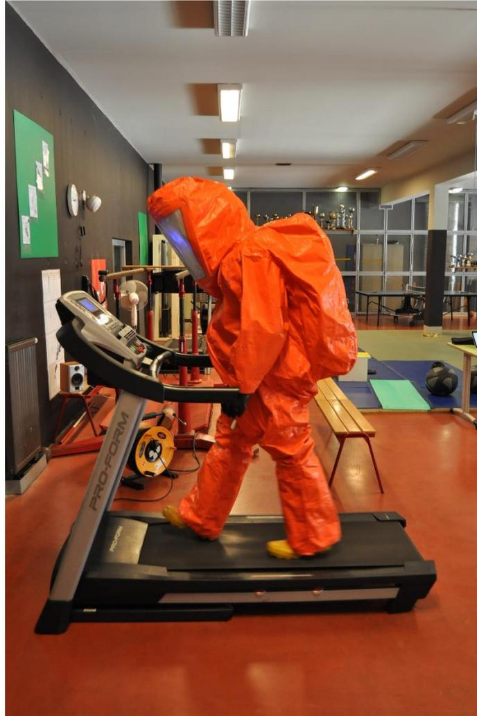
*Figure 16 : Equipier réalisant la manœuvre avec l'ARI porté sous l'EPI de type 1A*
