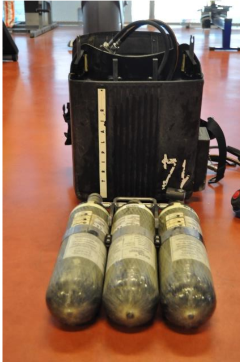
Figure 4 : ARI dit « TRIPLAIR ® » : carter et bloc bouteilles
