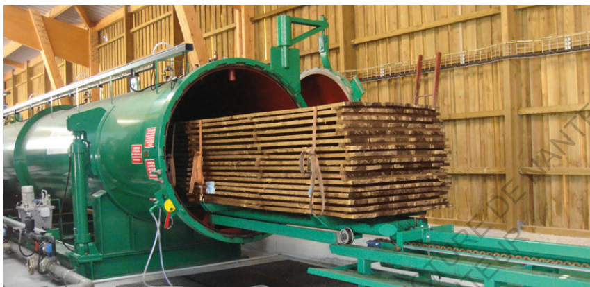
Image 3_ Technique de traitement autoclave 7
