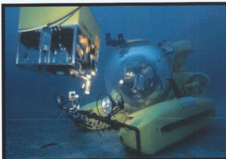
Illustration 4 : Vue sous-marine du Remora 2000 et du robot Super-Achille
