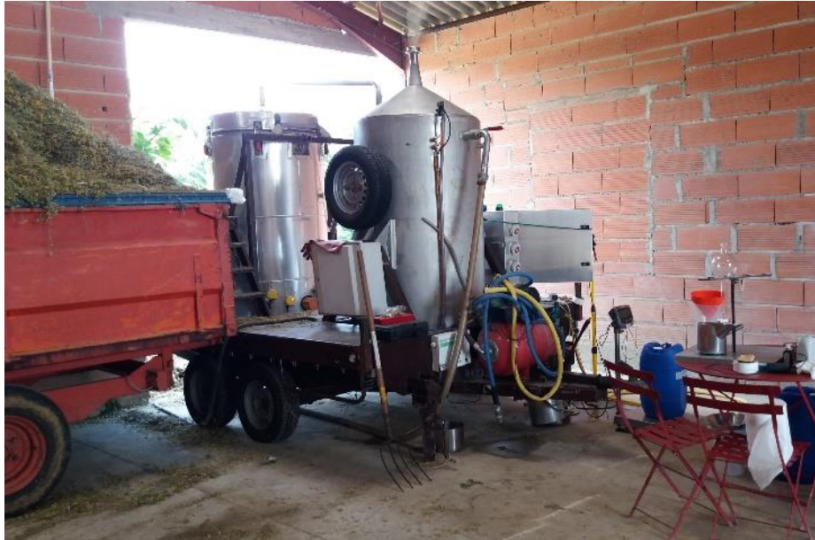
Figure 32 : Alambic mobile utilisé actuellement pour la distillation de l'hélichryse par PFA (S. Kling)
