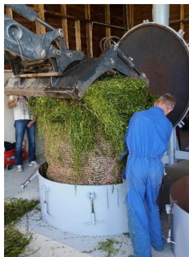
Figure 18 : Chargement de la cuve de distillation avec une balle fraîche de matricaire (S. Kling)
