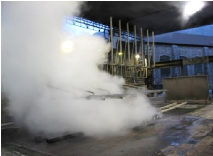
Figure 12: Refroidissement des BCC à l'eau
