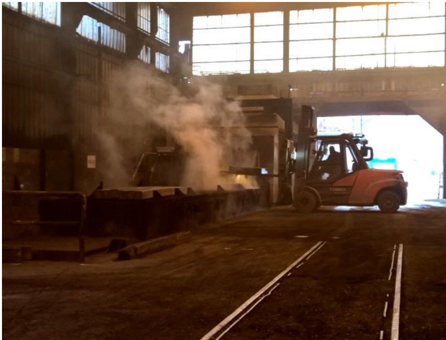
Figure 14: Chargement de la ferrocut par fenwick
