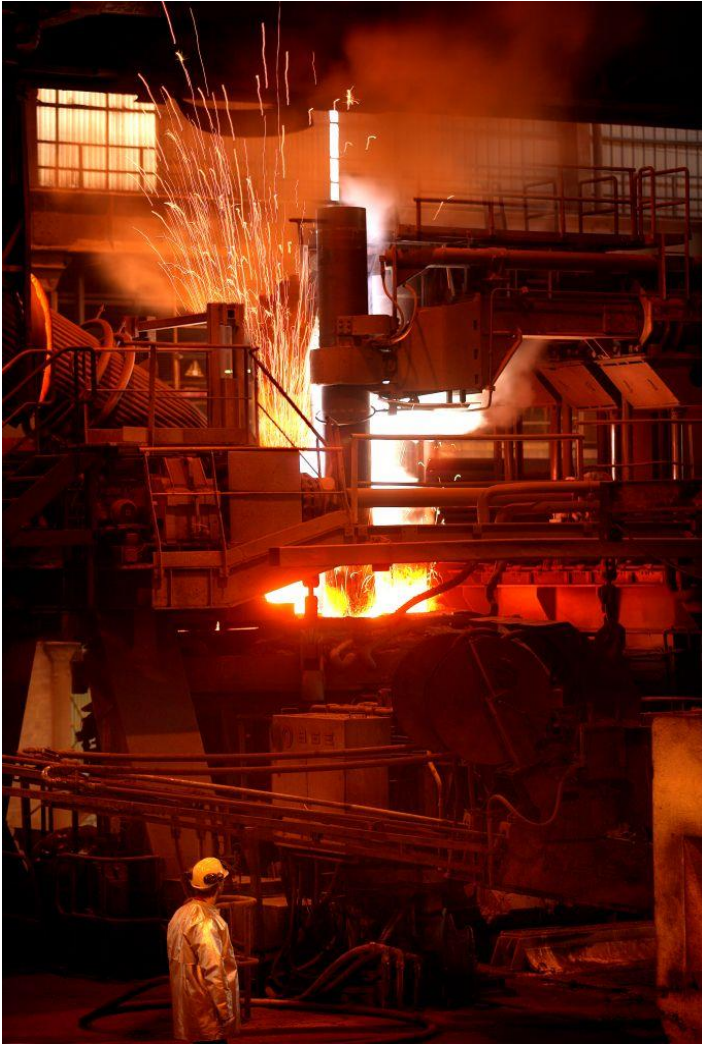
Figure 4: Opération de fusion de l'acier dans le four à arc électrique
