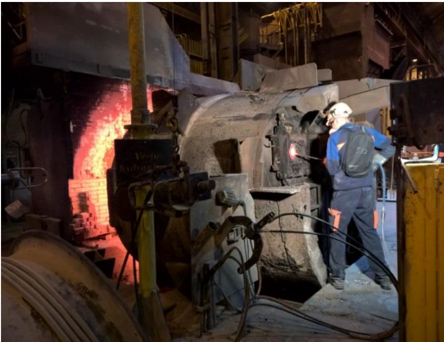
Figures 20 et 21: Opération de changement des plaques du tiroir de la poche
