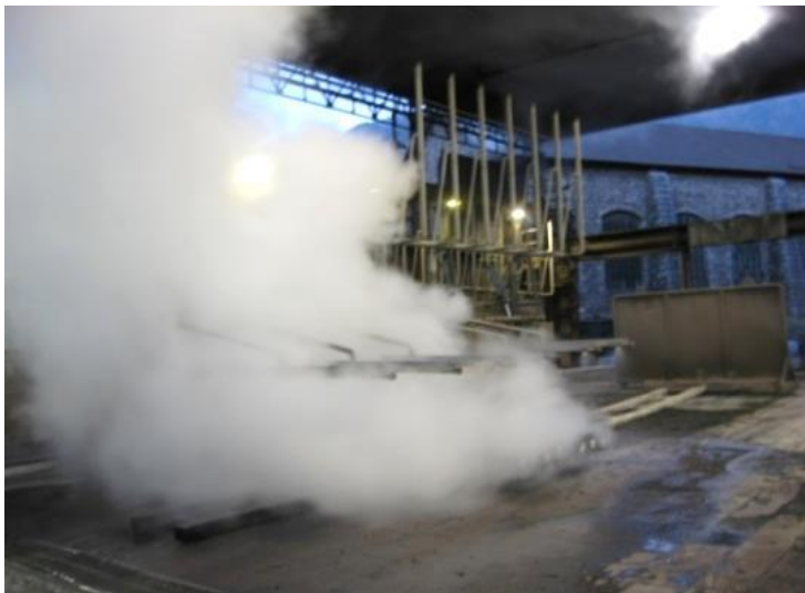
Figure 12: Refroidissement des BCC à l'eau
