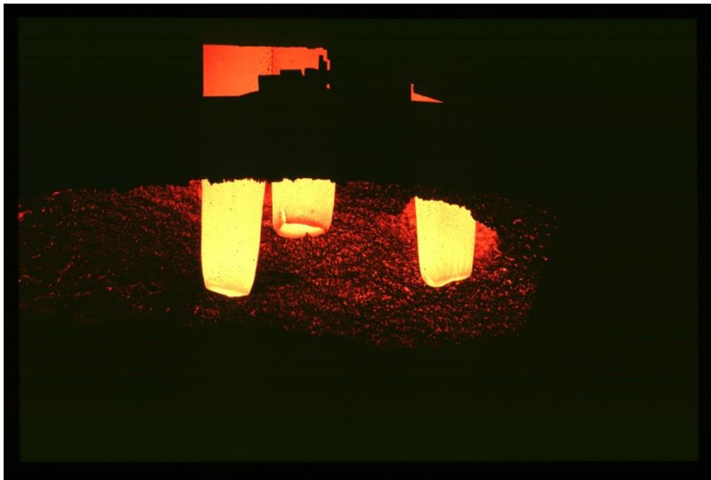
Figure 9: Début de coulée verticale
