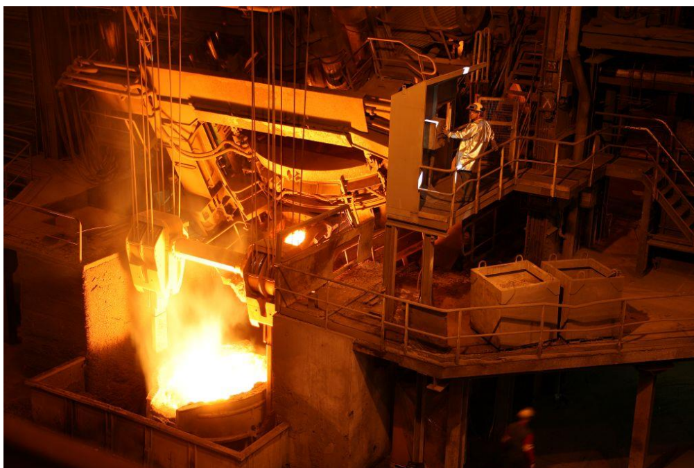
Figure 15: Opération de basculement du four dans la « poche de transfert »
