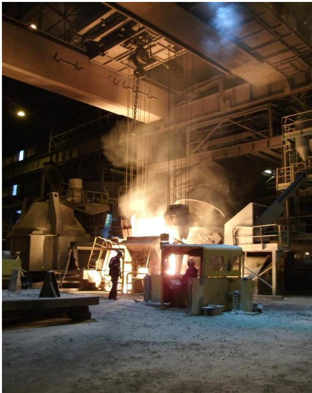
Figure 6: Zone de l'AOD comprenant un convertisseur contenant le métal liquide, une torche aspirant les fumées, une plateforme de décrassage mobile pouvant se relever lors de la fusion et une cabine de basculage où vient se placer l'opérateur lors du basculage du convertisseur
