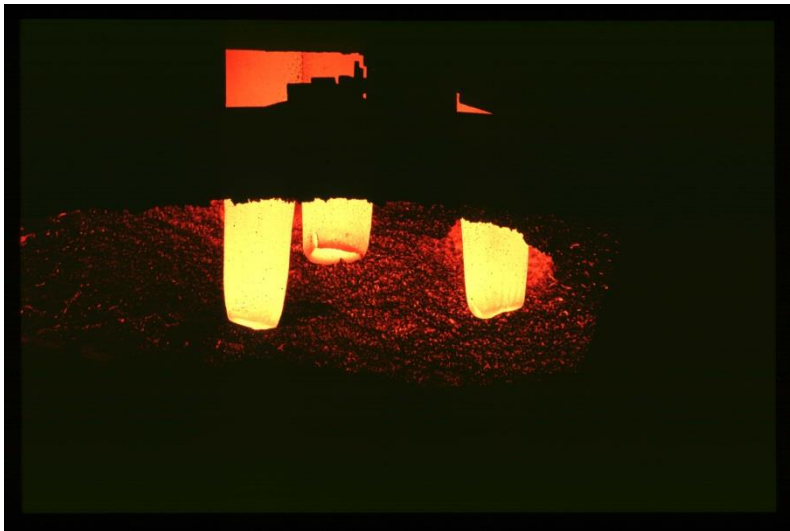
Figure 9: Début de coulée verticale
