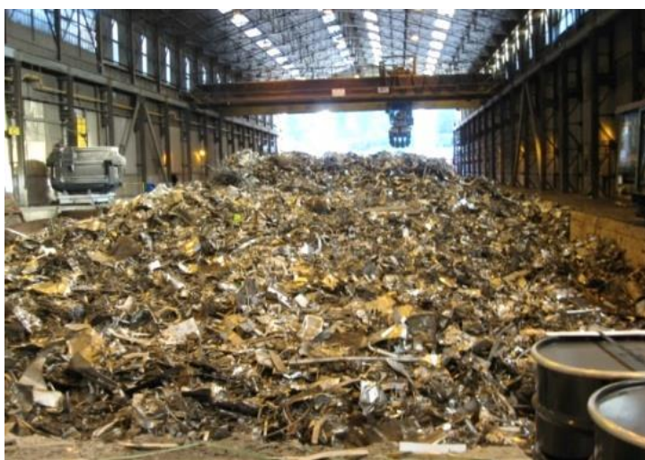
Figure 2: Hall 3 avec panier (à gauche), cabine suspendue (en haut) et trémies de stockage des matières premières (en bas)
