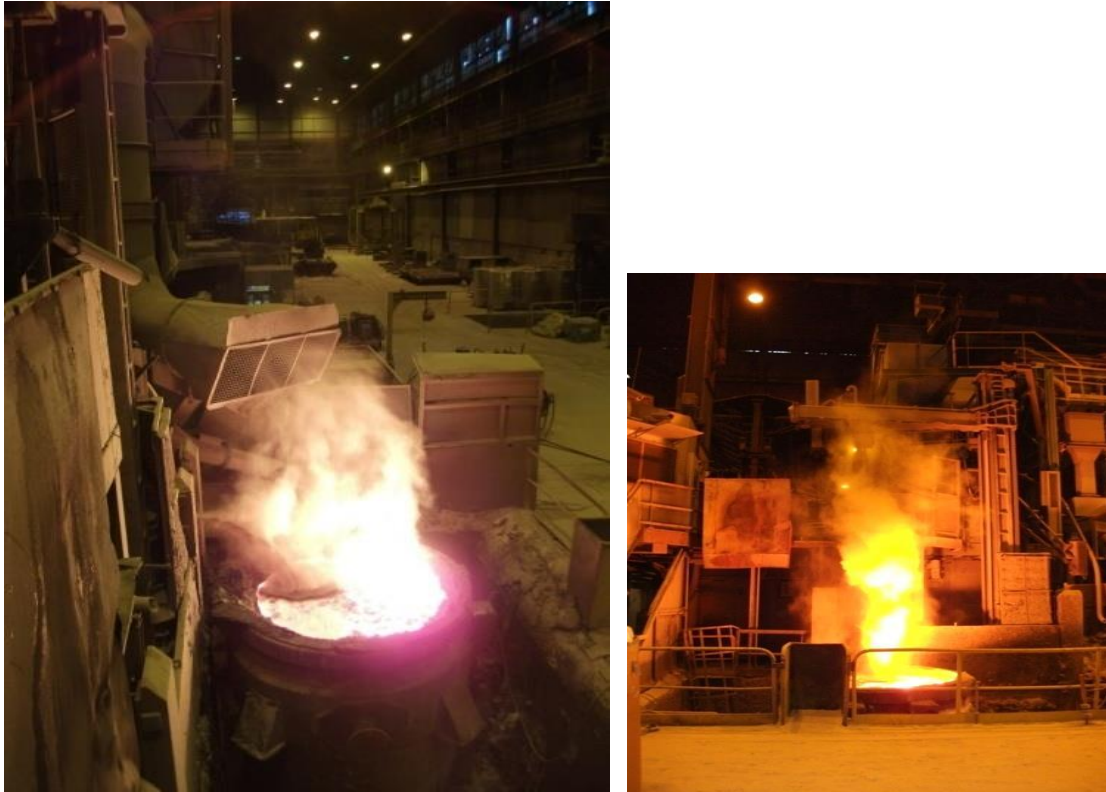
Figure 7 et 8: Station de bullage de la Mep (à droite) et affinage de la composition de l'acier par addition de composants (à gauche)
