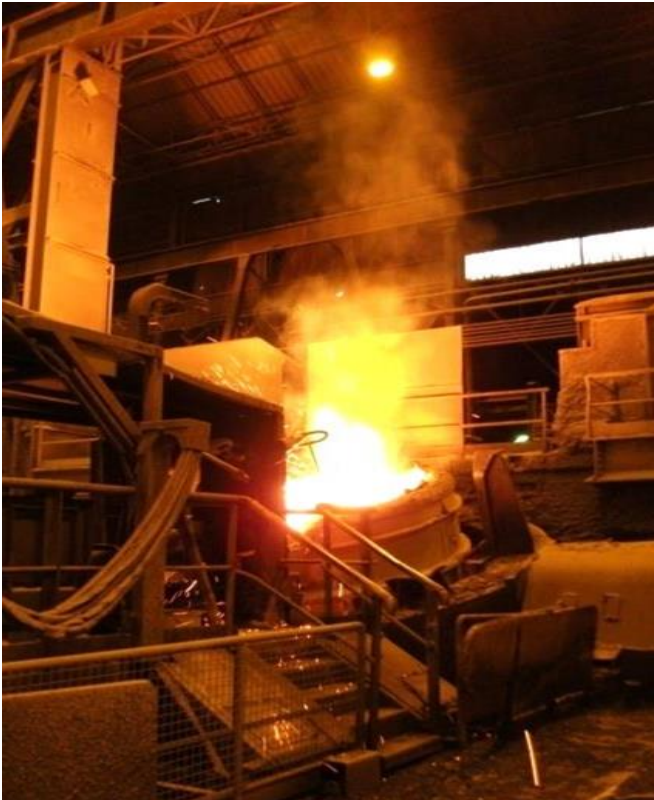
Figure 17: Opération de décrassage de la poche d'acier
