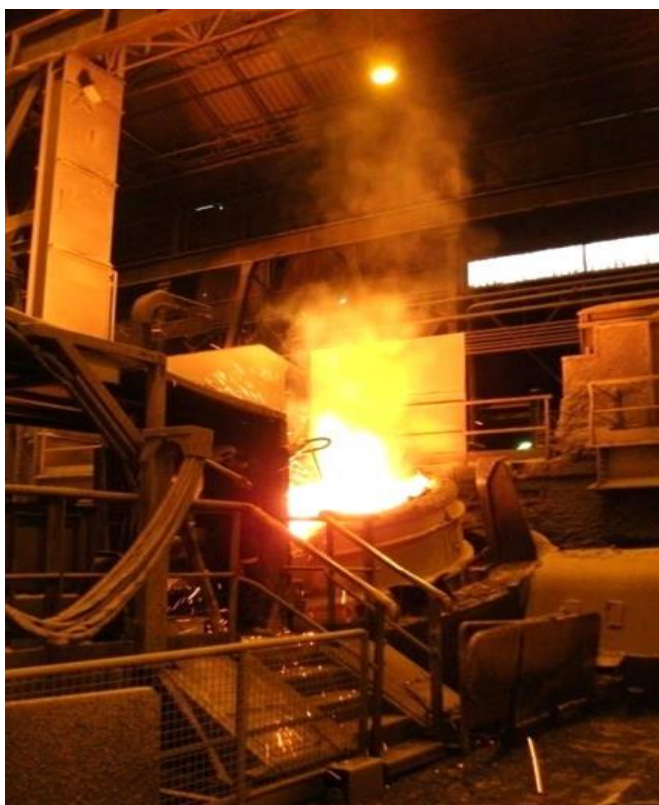
Figure 17: Opération de décrassage de la poche d'acier
