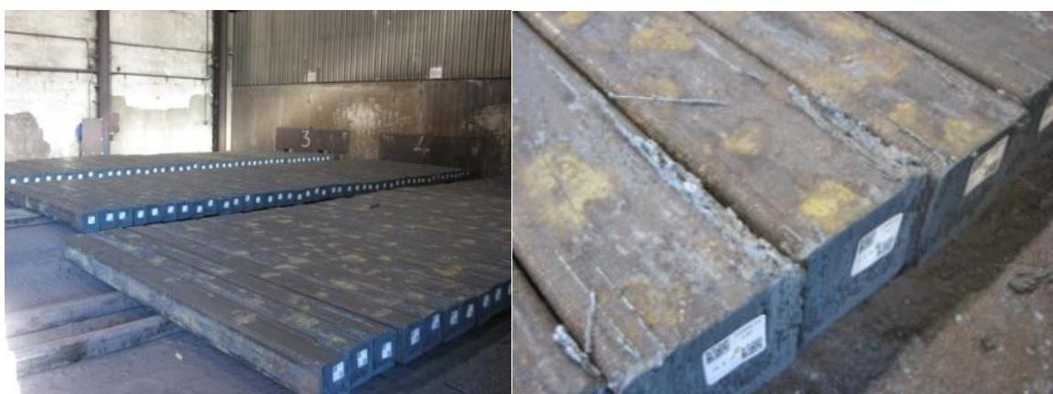
Figure 28 et 29: Hall de refroidissement des BCC à l'air libre (à gauche) et BCC avec à leurs surfaces des dépôts de calamine (à droite)
