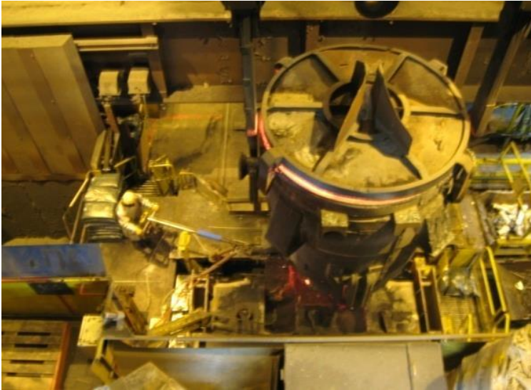
Figure 23: Ouverture de la poche à l'aide d'un vérin pneumatique
