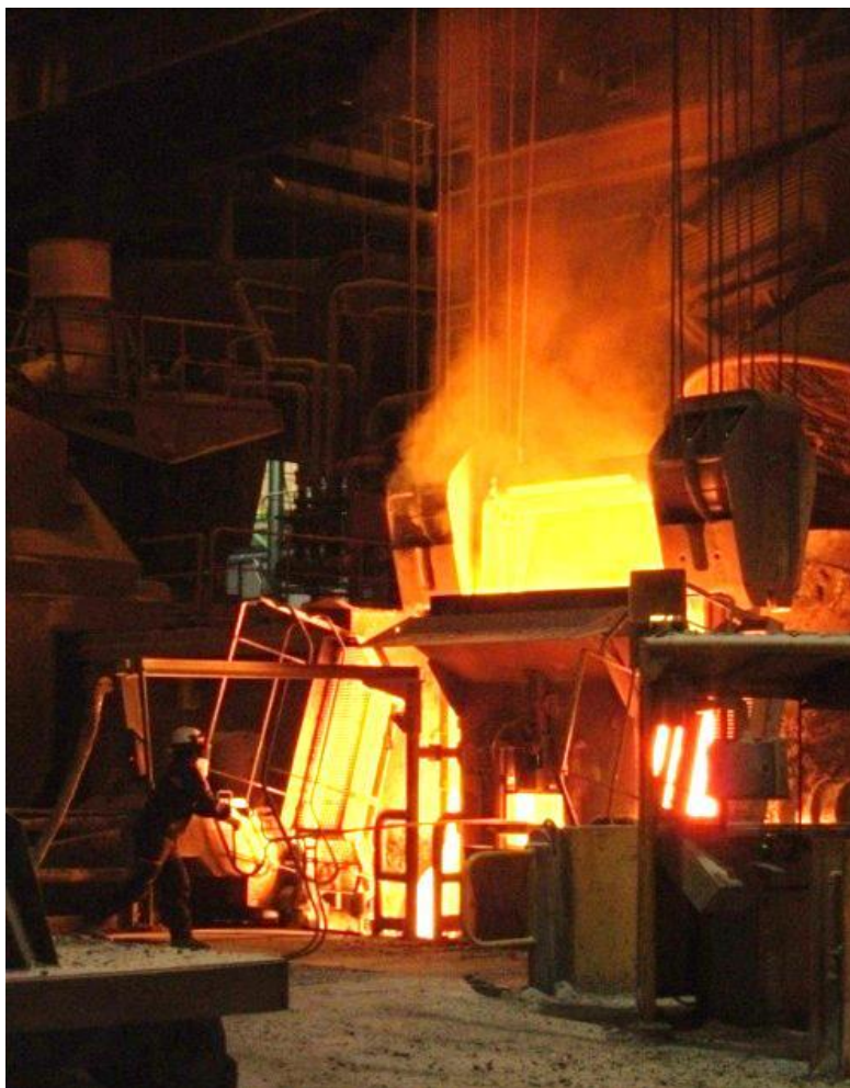
Figure 21: Opération de décrassage du laitier par l'aodiste
