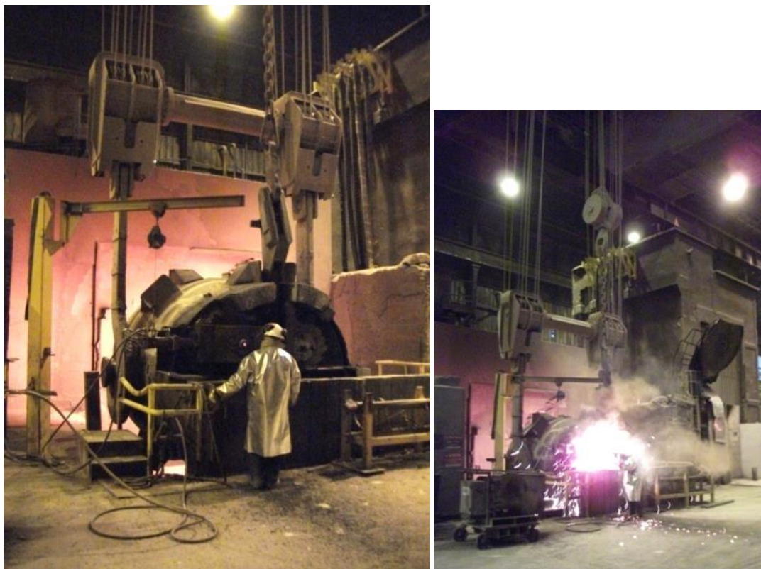
Figure 18 et 19: Débouchage du « trou de coulée » à la lance à oxygène
