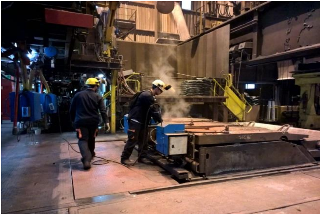
Figure 24: Opération de contrôle et nettoyage à la soufflette des répartiteurs
