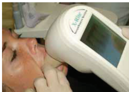
Fig 56 : Prise de teinte avec le Shade Vision de Xrite (Pignoly et al., 2010)
