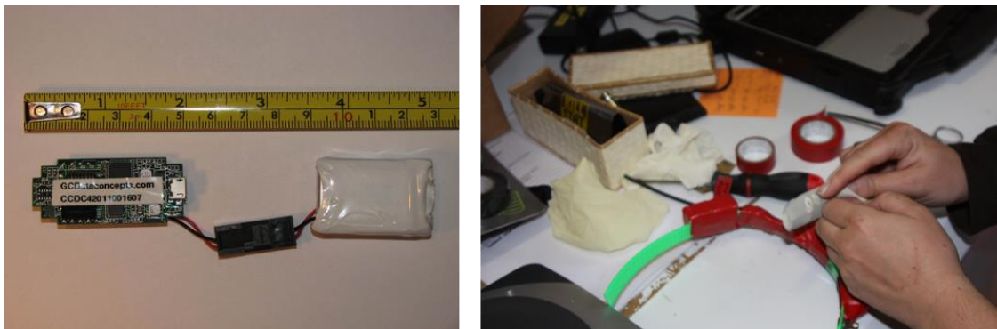
Figure 1. Accéléromètre tridimensionnel X6-2 mini (batterie 1000 mAh et processeur) à gauche, protection de l'unité contre l'humidité et les chocs à droite. Issue de Forin-Wiart (2014)
