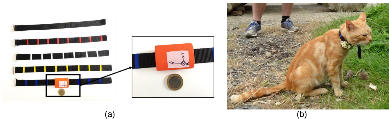
Figure 2. (a) Colliers et station inertielle déployés en 2016 (CNRS, M.-A. Forin-Wiart) ; (b) individu A équipé d'une station inertielle
