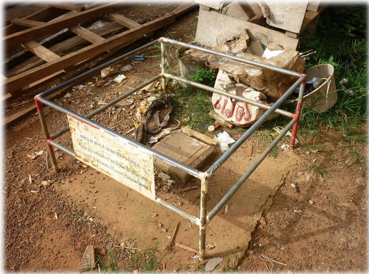
Figure 6 : Une borne du réseau géodésique national 42 déterminé en 2011 dans le quartier de Biyem Assi, au Sud-Ouest de Yaoundé (Photo de l'auteur, mai 2015)
