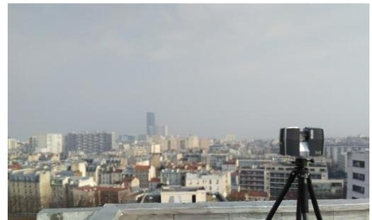
**Figure 2 : Faro Focus 3D pour relevé 3D d'immeuble de bureaux** (Source : Prise de vue personnelle - 2016).
