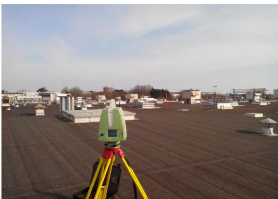
**Figure 3 : Leica P20 pour relevé 3D de toiture de centre commercial** (Source : Prise de vue personnelle - 2015).
