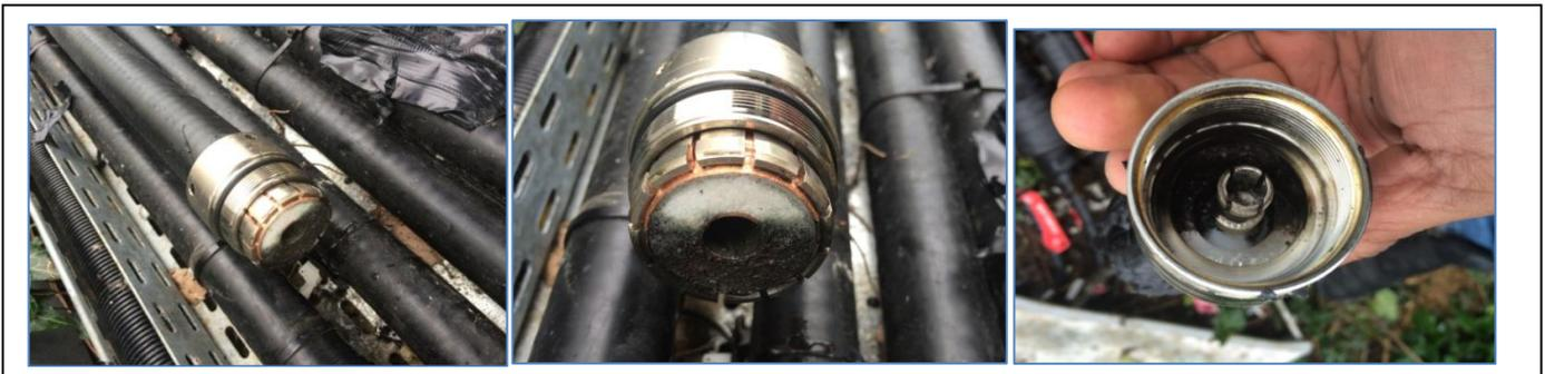
Figure 34 : Photos connecteur endommagé
