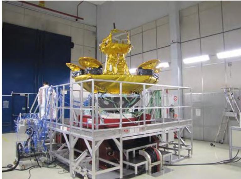
**Figure 2 Banc de test vibration**
