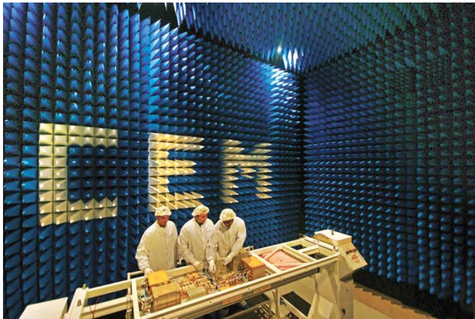
Figure 1 Test en chambre anéchoïque
