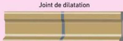
Quelle doit être la longueur du joint de dilatation entre deux rails de chemin de fer en acier si la longueur d'un rail est de 30 m à 0 °C et si la température à laquelle il est soumis peut aller jusqu'à 50 °C ?
